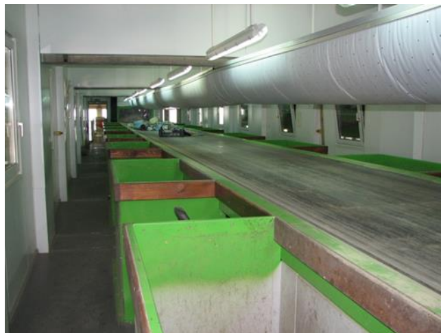
Slika 3. Sortirna kabina, kjer se vrši ročno odbiranje sekundarnih surovin (vir: Arhiv CEROZ)
